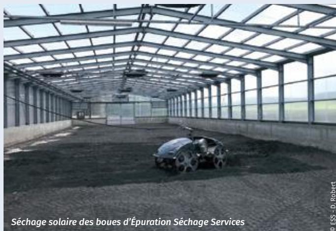
Séchage solaire des boues d'épuration Séchage Services
