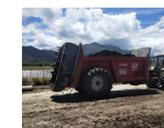
Epandeur utilisé pour les boues séchées
