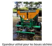
Epandeur utilisé pour les boues séchées
